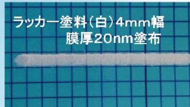
噴漆塗料(白) 4mm寬 膜厚20nm塗佈
